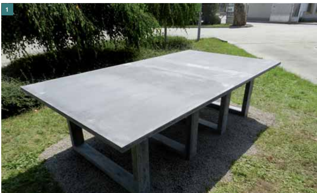
Obr. 1 Stůl sestavený z tenkostěnných prvků z UHPC ■ Fig. 1 Finished table composed of thin-walled components made of UHPC
