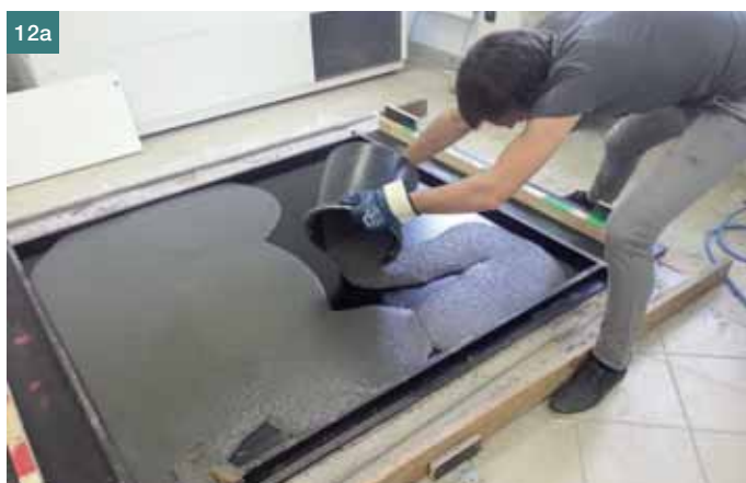
Obr. 12 a) Betonáž hrací desky, b) betonáž žeber desky ■ Fig. 12 a) Concreting of the slab, b) concreting of the ribs
