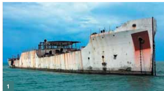
Obr. 1 Betonová loď S. S. San Pasqual z první světové války ■ Fig. 1 Concrete ship S. S. San Pasqual from the First World War
