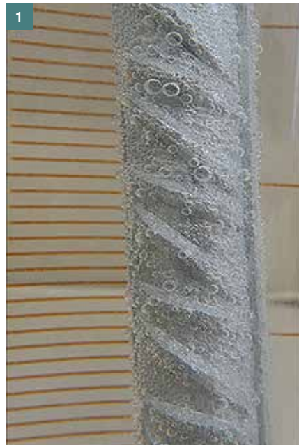
1 Demonstrace vývoje vodíku katodickou korozní reakcí při korozi žárově zinkované výztuže v modelovém pórovém roztoku betonu při pH 13,5 ■ 1 Demonstration of hydrogen evolution by cathodic corrosion reaction during corrosion of hot-dip galvanized reinforcement in model concrete pore solution at pH 13,5
