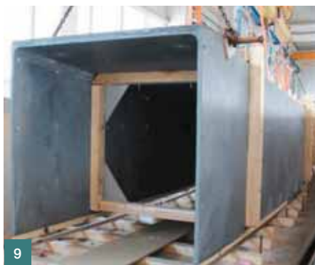
Obr. 10 Přeprava odbedněné lávky na místo pro vyzrání ■ Fig. 10 Transportation of the demoulded footbridge to the spot for ageing
