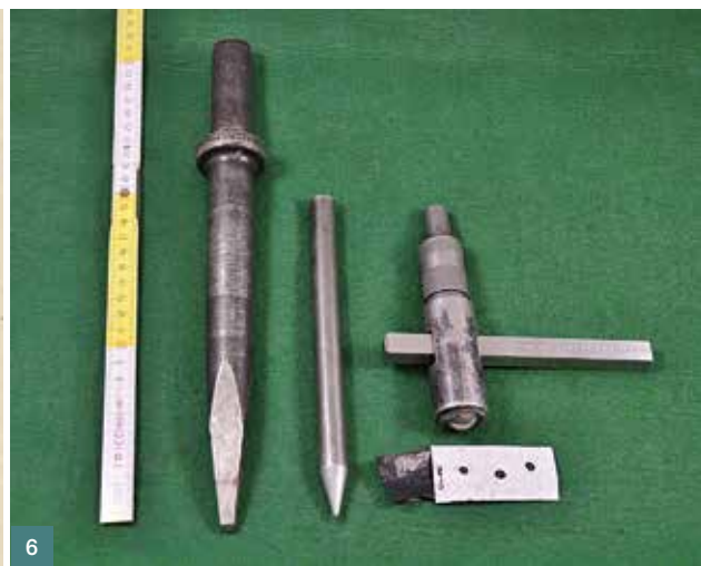
4 Řez upraveným Poldi kladívkem dle doc. K. Waitzmann (zdroj: [3]) 5 Dláto a vztah mezi pevností betonu a hloubkou jeho vniku do betonu dle Maška (zdroj: [3]) 6 Zleva: Maškův špičák, Cigánkův špičák a upravené Poldi kladívko dle Waitzmann 7 Zkouška špičákem podle Maška (nahore) a Cigánka (dole) se liší jednak tvarem a velikostí zkušebního dláta, jednak vzdáleností, ze které se provádí 20 „normálních“ úderů paličí o hmotnosti 2 kg (ilustrace: Jan Cíkrle)
